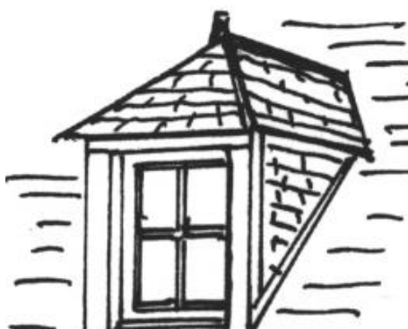
La lucarne à capucine Avec trois pans de couvertures
